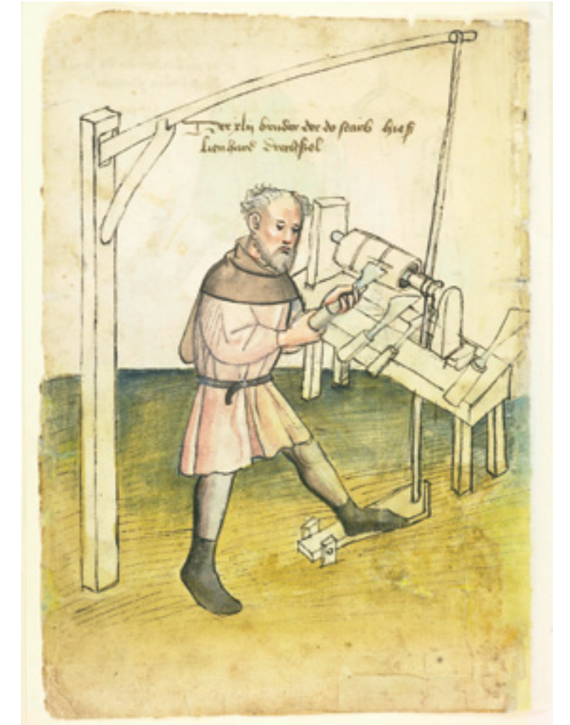
Fig. 6b: Bow and spring pole-driven lathe, Wood turner, from: Hausbuch der Mendelschen Zwölfbrüderstiftung, Band 1. Nürnberg 1426–1549. Stadtbibliothek Nürnberg, Amb. 317.2 o , fol. 18v / 8047b
